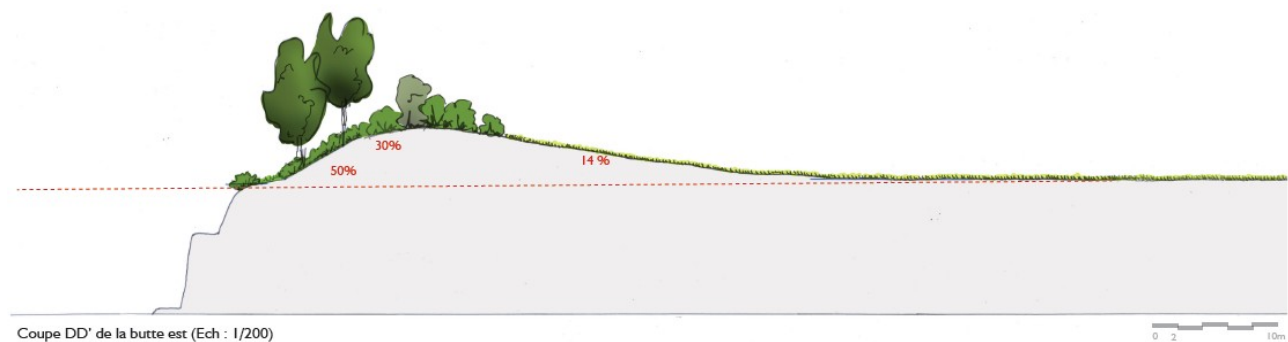
Extrait du Plan de paysage des sites carrières en Avesnois – Carrière de Glageon – Coupe de principe d'un merlon en pente douce
